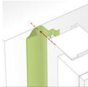
Klebung "wechselseitig": - Durch Abziehen der Abdeckfolie der Selbstklebung ankleben auf der Außenseite des Blendrahmens - Die Verklebung an der Wand muss von der Folienkante bis zur rot gekennzeichneten Linie vollflächig erfolgen
